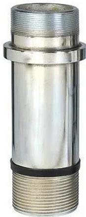
Os adaptadores superiores de aço inoxidável, possuem, de um lado, a rosca quadrada para conectar o Tubo Superior de uPVC, e, do outro lado a rosca BSP para as conexões da cabeça do poço.
